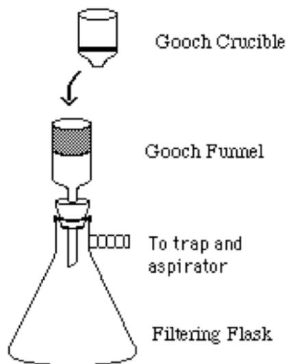
**Figure 1. Filtration apparatus**
